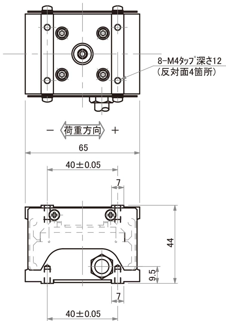
注) 図中の矢視+方向荷重にて標準アンプ出力は+方向に動作
