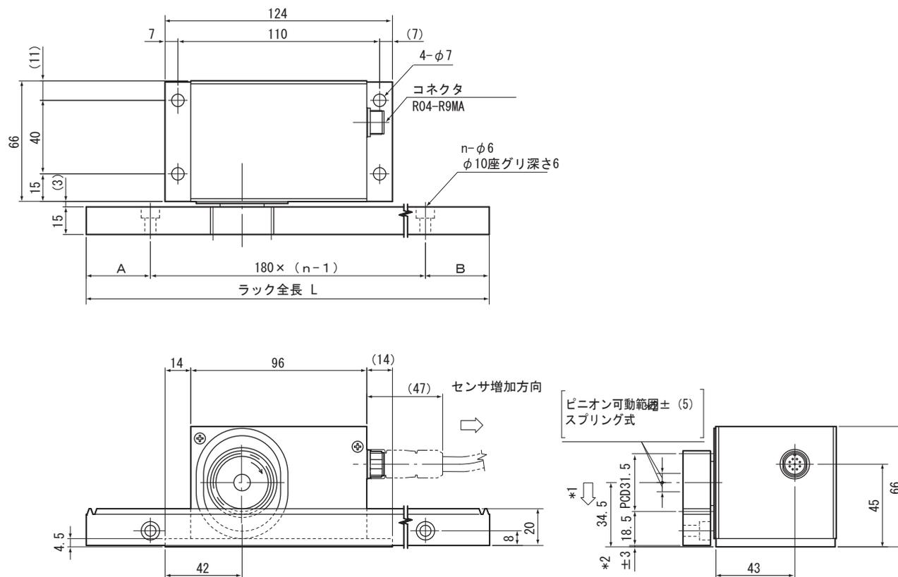
\*1 : ピニオンは約14Nの力で、矢印の方向（ラック）に押し付けられます。
